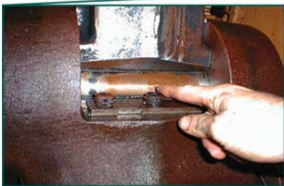
Figura 2. Herrumbre en el pasador de biela
